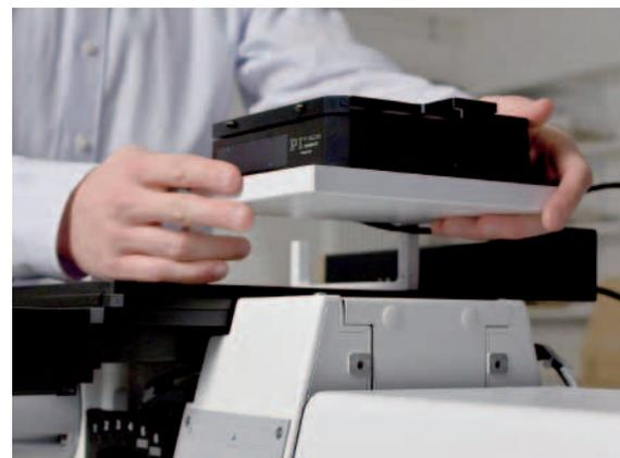
Die Feinjustierung der Probe übernimmt das Piezosystem, das in das Laserlithographiesystem von Nanoscribe integriert wurde. (Foto: Nanoscribe)
