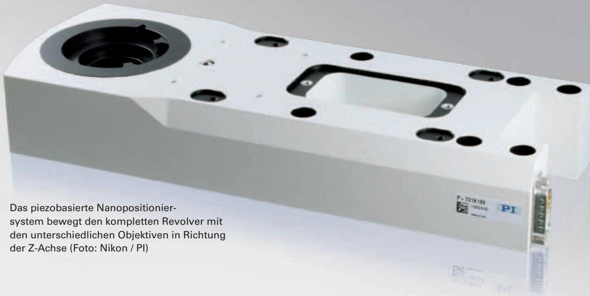
Das piezobasierte Nanopositioniersystem bewegt den kompletten Revolver mit den unterschiedlichen Objektiven in Richtung der Z-Achse (Foto: Nikon / PI)
