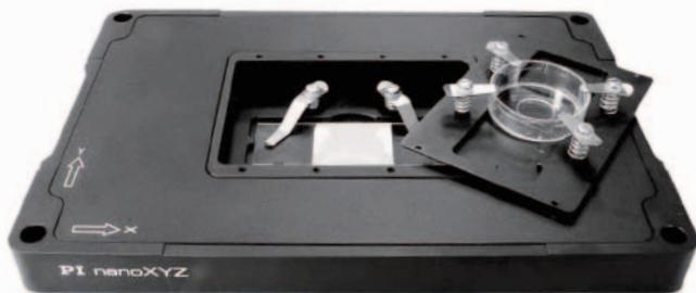
Bei inversen Mikroskopen oder Anwendungen, bei denen durch die Positionierung der optische Strahlengang nicht verändert werden soll, bieten sich piezobasierte Scantische an, die sich dank ihrer geringen Bauhöhe gut in die Mikroskope integrieren lassen. (Foto: PI)
